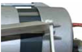
Ontgrendelingssysteem via hendel op de actuator met kabel.
