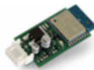
P-250T-WIFI Dispositif de connexion WIFI 2,4 GHz qui permet d'utiliser le portable à distance grâce à l'application TauApp pour programmer et contrôler les centrales de commande
