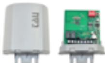
P-900TWM Récepteur maître pour interface centra- le (gère jusqu'à max. 4 TWC)
