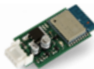
P-250T-WIFI Dispositif de connexion WIFI 2,4 GHz qui permet d'utiliser le portable à distance grâce à l'application TauApp pour programmer et contrôler les centrales de commande ( sauf P-500MASTER20T )
