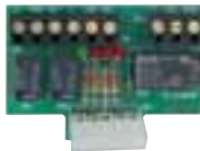
SCHEDA OPZIONALE A 3 RELÉ PER LUCE BOX O ELETTROMAGNETE E GESTIONE SEMAFORO Three relay equipped optional card for box light or electromagnet and traffic light control Tarjeta opcional con 3 relés para luz box o electroimán y gestión semáforo Fakultative Platine mit 3 Relais für Boxlicht oder Elektromagnet und Ampelsteuerung ACQ9081
