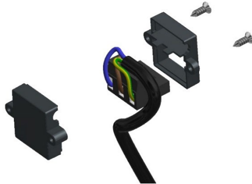
2. Sluit de kabel aan op de voedingsklem.
