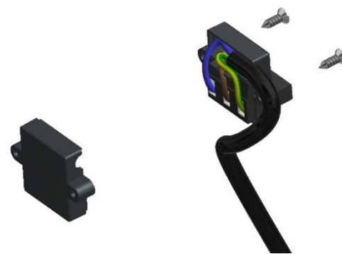
3. Steek de bekabelde klem in de beschermende omhulling.
