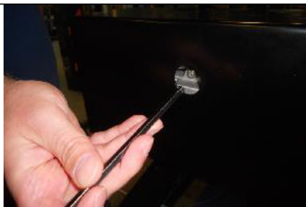
2 Placez la clé Allen dans la tête de vis.
