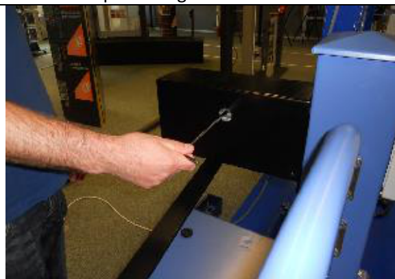
5 Tournez dans le sens inverse des aiguilles d'une montre pour réaccoupler le moteur.
