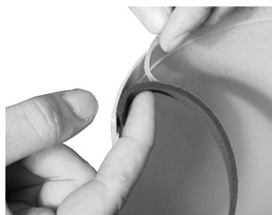
Installation der Dichtung
