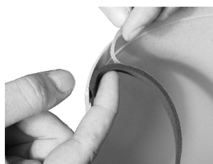
Installation der Dichtung
