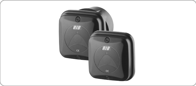
FOTOCELLULE FIT SYNCRO DA PARETE - cod. ACG8026 Portata settabile 10+20mt Sono applicabili più coppie ravvicinate tra loro grazie al circuito sincronizzatore. Aggiungere il TRASMETTITORE SYNCRO cod. ACG8028 per più di 2 coppie di fotocellule (fino a 4) COPPIA DI CESTELLI DA INCASSO PER FIT SYNCRO cod. ACG8051 COPPIA COLONNINE PORTA FOTOCELLULE FIT SYNCRO H=0,5mt cod. ACG8057
