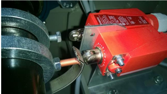
Figure A ; fin de courses, normalement, ne pas régler ici!
