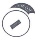
Poti noir pour le réglage Du temps de remise en marche du moteur
