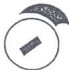
Poti vert pour le réglage du temps de fonctionnement automatique entre 10 et 80 sec
